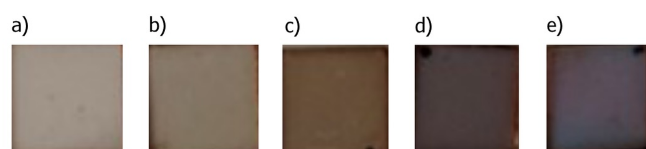
Rys. 1: a) Niemodyfikowany poliwęglan (PC), b) TiO 2 @PC_500, c) TiO 2 @PC_1000, d) TiO 2 @PC_1500, e) TiO 2 @PC_2000.
