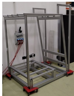
Projekt II.PN.08. Komponenty części fizycznej symulatora podnośnikowego wózka jezdniowego. Od lewej: platforma obrotowa i rama kabiny
