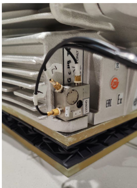
Projekt I.PN.10. Ustrój antywibracyjny 3D zastosowany do redukcji drgań pompy próżniowej
