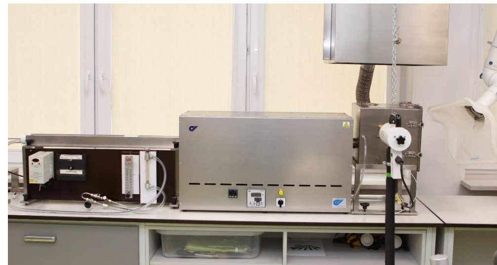
Zdjęcie stacjonarnego pieca rurowego
