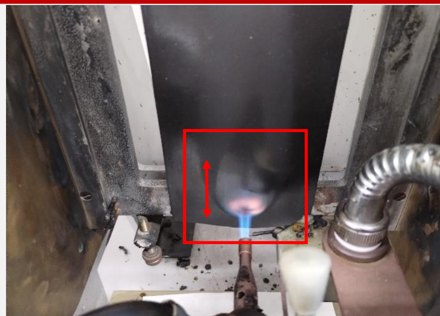
Materiał PVC „B” przeznaczony na elementy obuwia ochronnego z zastosowaniem dodatków uniepalniających
