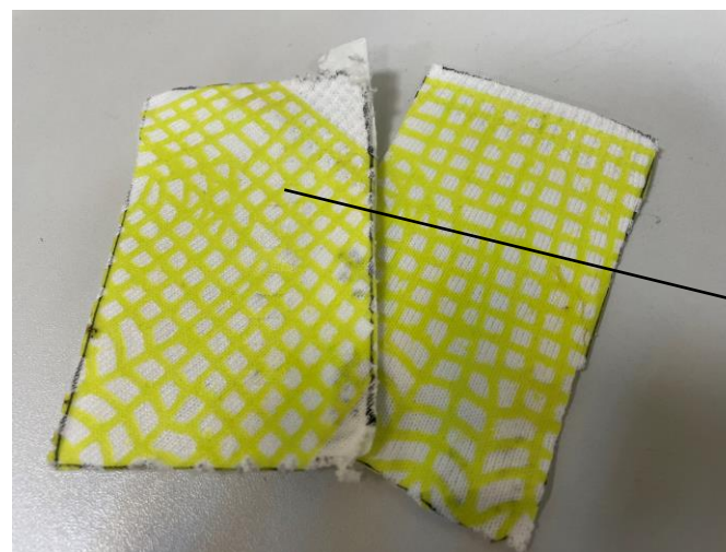
Próbki dzianiny poliestrowej ze wzmocnieniem polimerowych przygotowane do badania odporności na przecięcie (wycięta pod kątem 40°)
