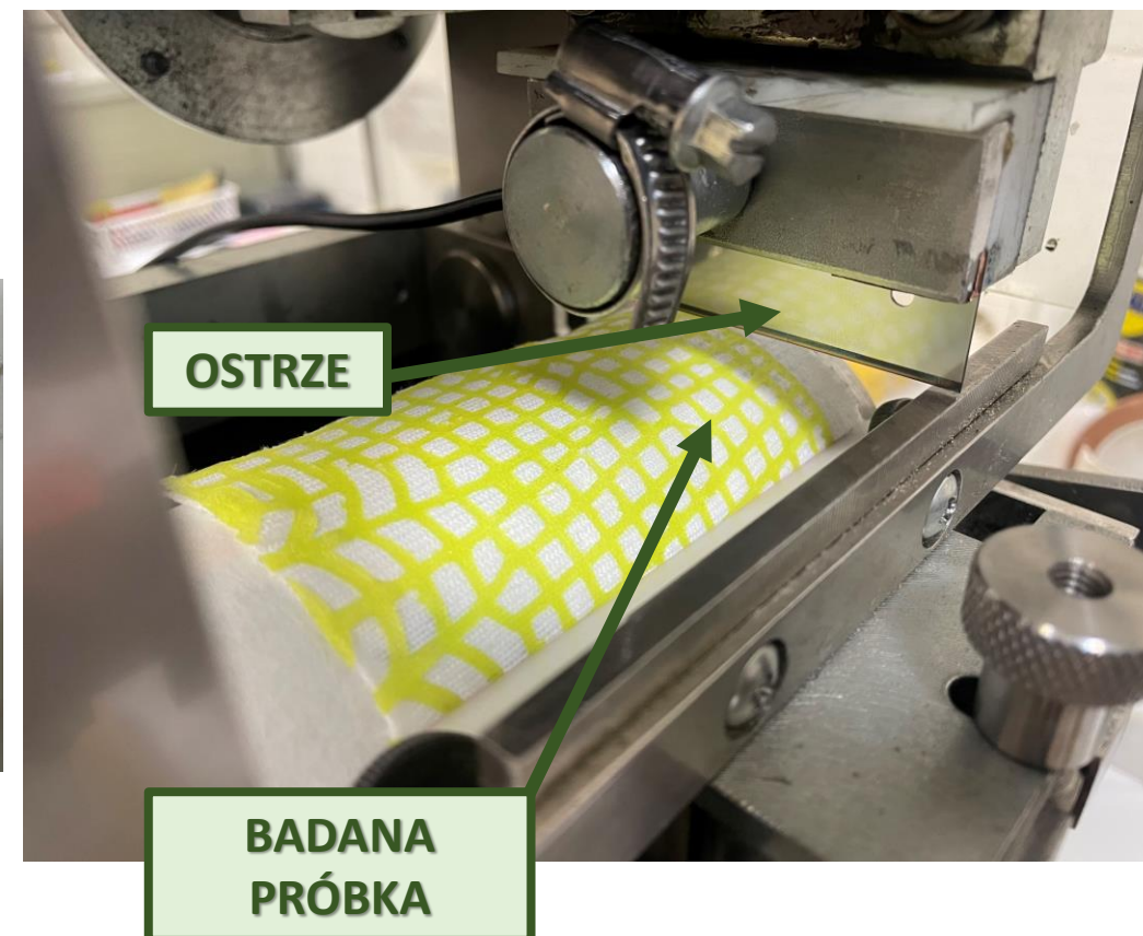
Próbki dzianiny poliestrowej ze wzmocnieniem polimerowych przygotowane do badania odporności na przecięcie (wycięta pod kątem 40°)
