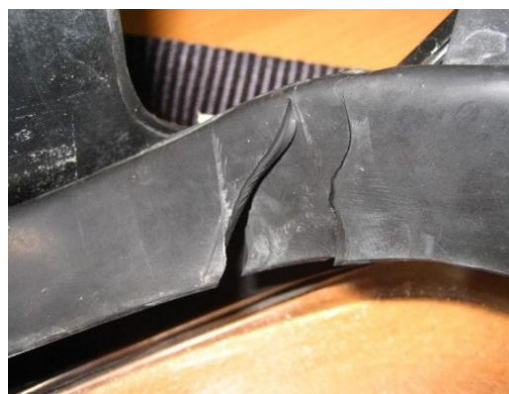
Rysunek 18. Pęknięcie korpusu maski
