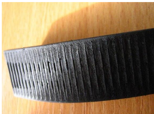
Rysunek 19. Uszkodzenie mechaniczne taśmy nagłowia
