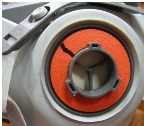
Rysunek 20. Pęknięcie uszczelki na łączniku
