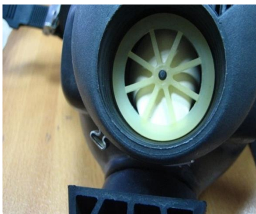
Rysunek 17. Uszkodzenie zaworu wydechowego
