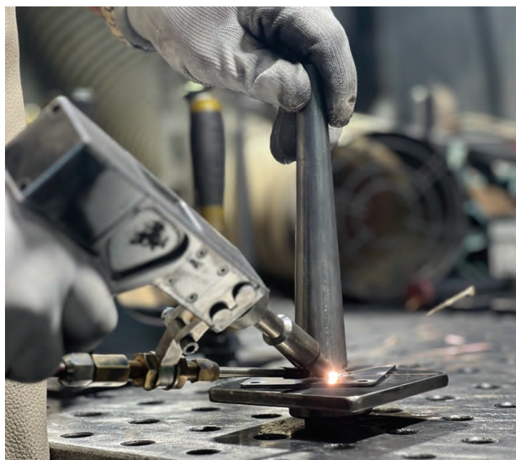
Rysunek 4. Przykład zastosowania lasera klasy 4. – ręczne spawanie laserowe. Źródło: CIOP-PIB (fot. M. Okrasa)
