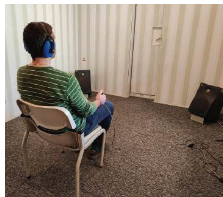
Fot. 1. Badanie tłumienia dźwięku w kabinie do pomiarów parametrów akustycznych ochronników słuchu
