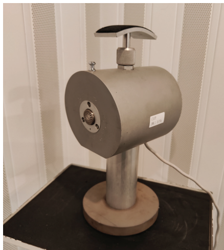
Fot. 2. Tester akustyczny służący do pomiaru tłumienia wtrącenia nauszników przeciwhałasowych według PN-EN ISO 4869-3:2009 [4]
