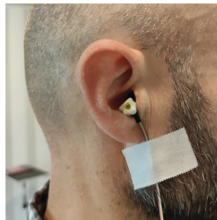
Fot. 3. Przykład umieszczenia mikrofonu miniaturowego w uchu osoby uczestniczącej w pomiarach parametrów akustycznych nauszników przeciwhałasowych
