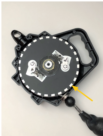
Fot. 2. Widok tarczy bębna z elementami refleksyjnymi (oznaczonymi strzałką)
