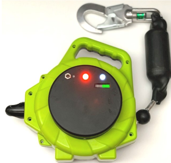
Rys. 9. Prototyp urządzenia do dynamicznego skracania drogi spadania z elektronicznym systemem sterowania blokowaniem linki.
