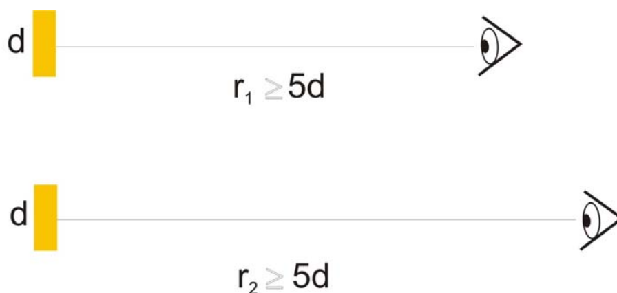
Rys. 7.3. Źródło punktowe – prezentacja graficzna fotometrycznego prawa odległości
