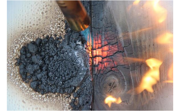
Element drewna pokryty i nie pokryty powłoką ogniochronną w trakcie ekspozycji na ogień
