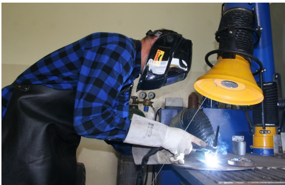
Zadanie 2.SP.07. Przykładowe stanowisko ręcznego spawania elektrycznego (metodą TIG), na którym dokonano pomiarów promieniowania nadfioletowego (UV) w celu oceny zagrożenia fotochemicznego oczu oraz skóry pracownika na promieniowanie UV
