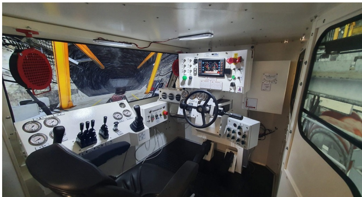
Projekt nr CuBR/III/9/NCBR/2017, KGHM-BZ-U-0223-2017. Wnętrze kabiny symulatora SWW; widoczny jest m.in. pulpit jazdy (nad kierownicą) oraz stanowisko wiercenia
