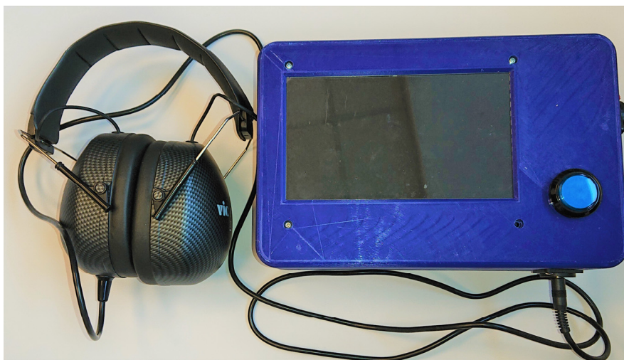
Zadanie 3.SP.06. Model testera do sprawdzania prawidłowego umieszczania wkładek przeciwhałasowych w zewnętrznym przewodzie słuchowym
