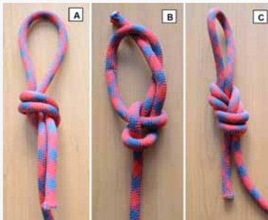
Rys. 2. Węzły na linie włókienniczej poddane badaniom. Oznaczenia: A – węzeł kluczka, B – węzeł skrajny tatrzański, C – węzeł ósemka Fig. 2. Tested knots on fibre ropes. Note: A – overhand loop, B – bowline loop, C – figure eight loop
