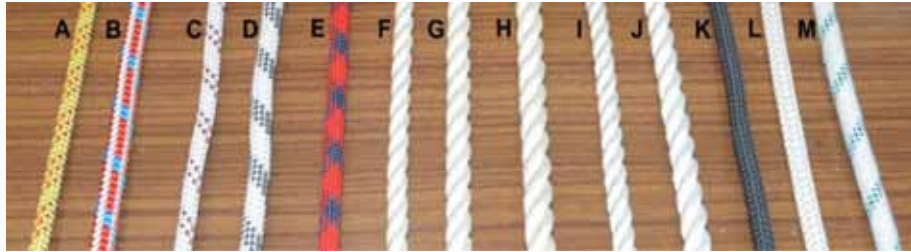
Rys. 1. Liny włókiennicze poddane badaniom Fig. 1. Tested fibre ropes
