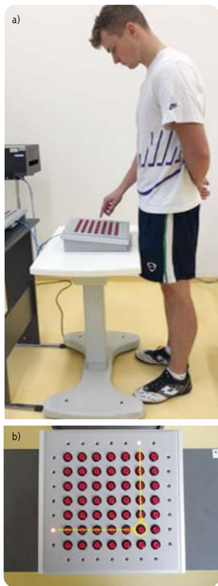
Fot. 3. Badanie koordynacji wzrokowo-ruchowej w teście krzyżowym: a) pozycja ciała badanego w czasie przeprowadzania testu; b) aparat krzyżowy ze zobrazowaniem zasady wykonania zadania przez osobę badaną
