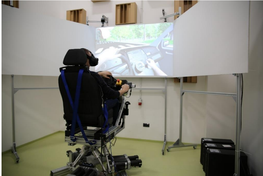
Rys. 3 Laboratoryjny symulator jazdy samochodem dostawczym wykorzystujący ruchomą platformę oraz metodę wyświetlania obrazu opartą o techniki rzeczywistości wirtualnej (obraz centralny na ekranach – w celu podglądu).
