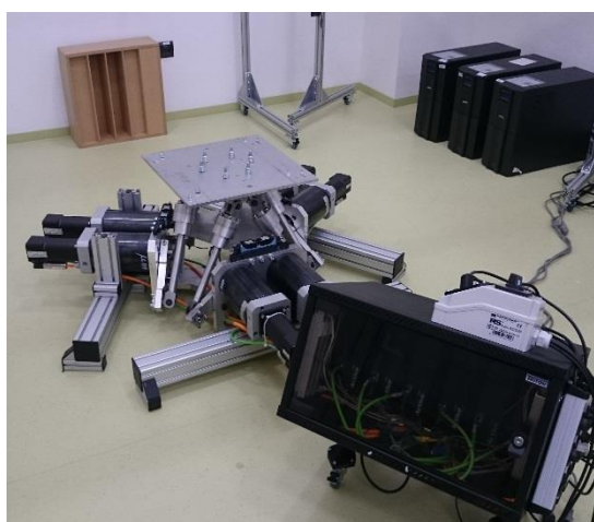
Rys.2 Ruchoma platforma o 6 stopniach swobody.
