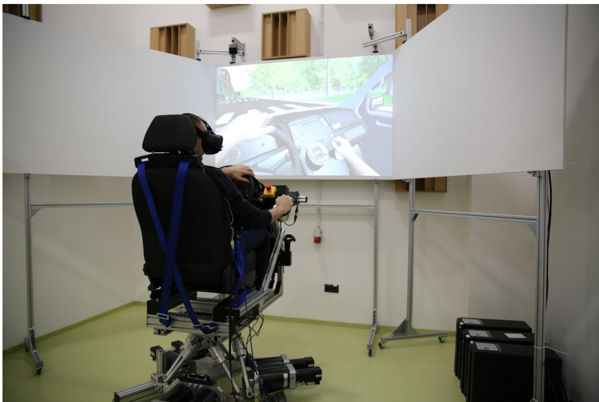
Rys. 4 Laboratoryjny symulator jazdy samochodem dostawczym wykorzystujący ruchomą platformę oraz metodę wyświetlania obrazu opartą o techniki rzeczywistości wirtualnej (obraz centralny na ekranach – w celu podglądu).
