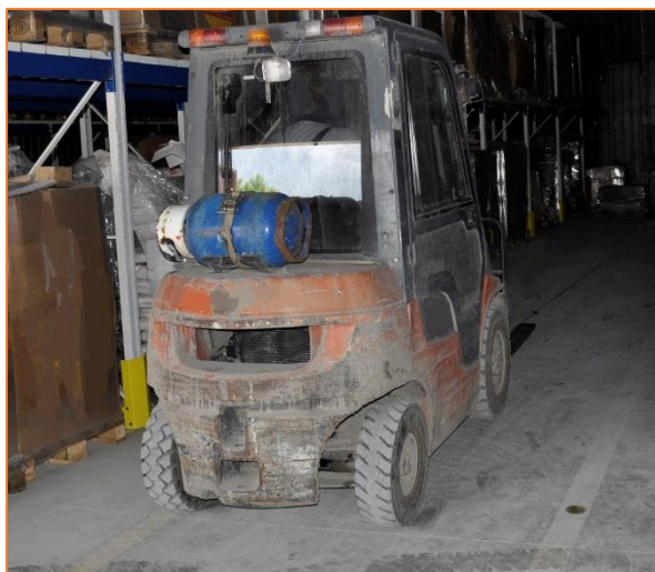
Rys. 9. Wózek jezdniowy jako przykład obiektu wyposażonego w sygnalizator, który jest zlokalizowany na wysokości głowy pracownika
