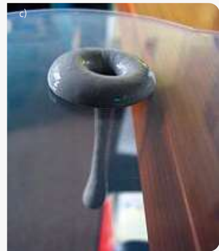
Rys. 9. Różne formy materiału plastycznego: a), b) – umożliwia dowolne formowanie, c) – pozostawiony bez ruchu „wypłylnie” przez otwór
