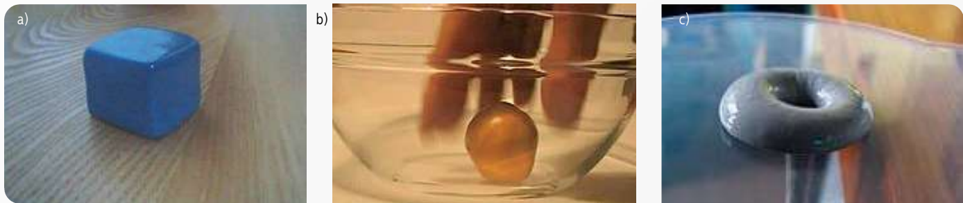
Rys. 9. Różne formy materiału plastycznego: a), b) – umożliwia dowolne formowanie, c) – pozostawiony bez ruchu „wypłylnie” przez otwór
