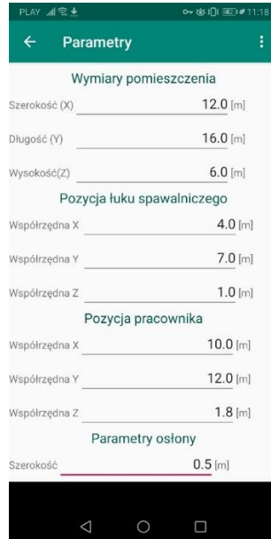
Rys.2. Wybór parametrów geometrycznych i spawania, część górna.
