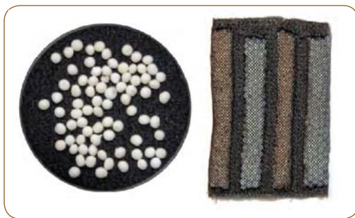
Fot. 2. Makrokapsulki PCM oraz wypełniony nimi wkład do bielizny typu A Photo 2. PCM macrocapsules and insert filled with them for underwear type A
