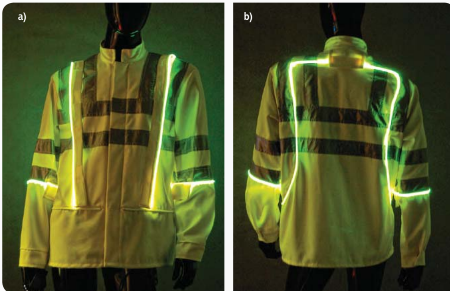
Fot. 9. Widok bluzy ostrzegawczej z wszytymi światłowodami optycznymi typu SEPOF (SCILIF): a) przód, b) tył Photo 9. A view of warning jacket with sewn SEPOF (SCILIF) type optical fibers: a) front, b) back
