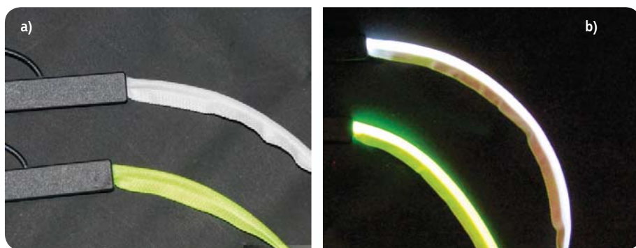
Fot. 8. Widok światłowódów SCILIF w oplotach: a) w stanie wyłączonym i b) włączonym Photo 8. A view of SCILIF optical fibers in braids: a) turned off b) turned on
