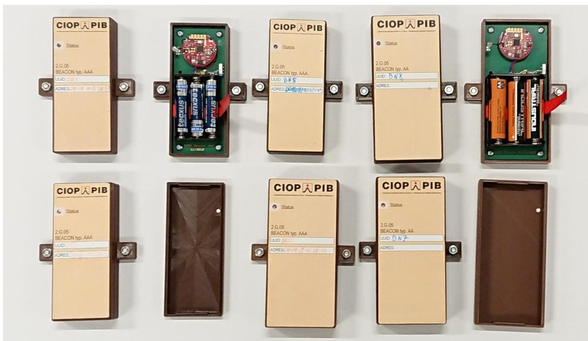
Rys. 6. Beacon i jego konstrukcja wewnętrzna.
