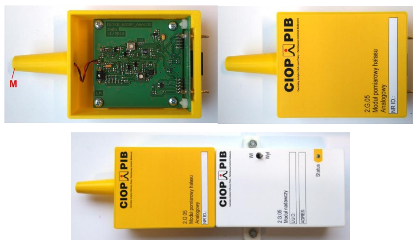
Rys. 4. Moduł sensorowy hałasu (u góry, M – mikrofon) oraz układ pomiarowy hałasu (u dołu).
