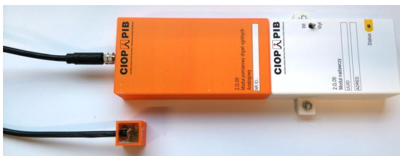
Rys. 5. Układ pomiarowy drgań, zawierający moduł sensorowy drgań (w kolorze pomarańczowym).
