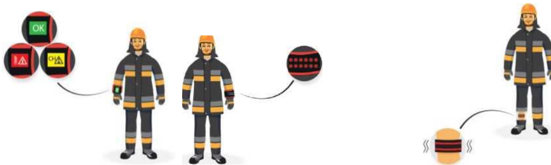
Rys. 1. Lokalizacja systemów sygnalizacji zagrożeń podczas badań użytkowych: a) SSZ z wyświetlaczem LCD, b) SSZ z diodami LED, c) SSZ z elementem wibracyjnym
