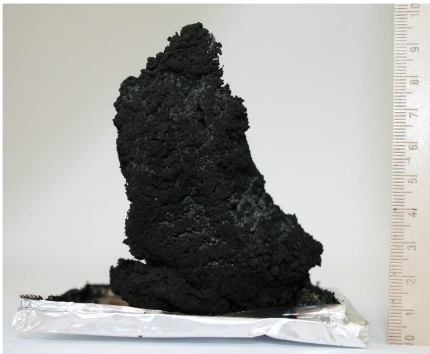
Rys.3. Przykładowy wygląd próbki zwierającej uniepaniacz intumescent po badaniu przeprowadzonym z wykorzystaniem kalorymetru stożkowego (fot. własna CIOP-PIB)
