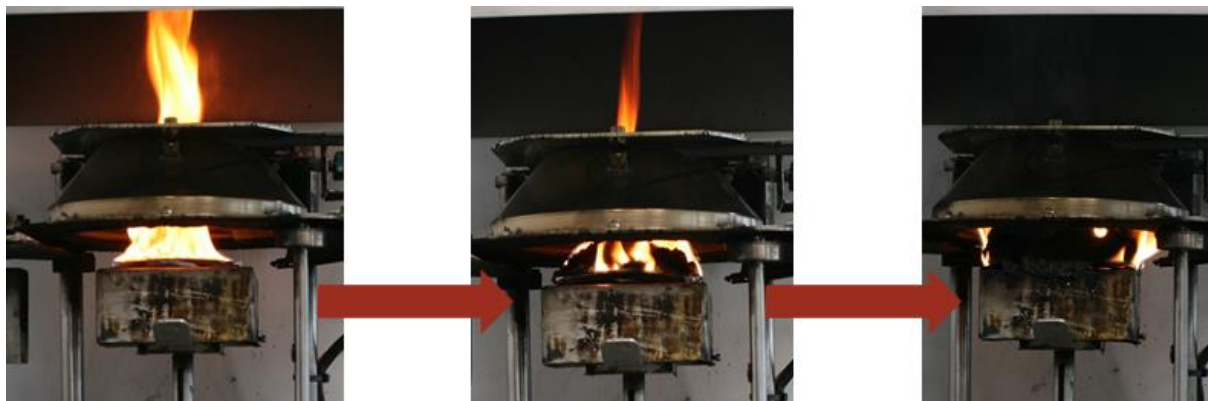
Rys. 2. Przebieg badania przeprowadzonego z wykorzystaniem kalorymetru stożkowego dla próbki tworzywa polimerowego zawierającej uniepaniacz intumescent (fot. własna CIOP-PIB)
