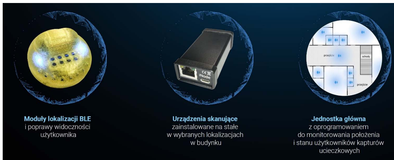
Rys. 3. Komponenty sprzętowe opracowanego rozwiązania (Źródło: CIOP-PIB, aut. Piotr Ragankiewicz)
