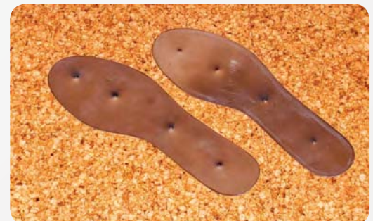
Fot. 2. Przykładowe wkładki antyprzebielowe (metalowe, prawe) po badaniu odporności na przebicie wg PN-EN 12568:2011
