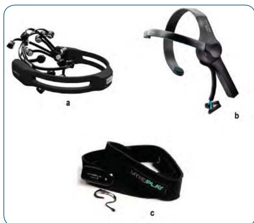
Rys. 1. Przykładowe bezprzewodowe urządzenia wykorzystujące sygnały EEG, powszechnie stosowane w systemach BCI: (a) Emotiv EPOC+, (b) NeuroSky MindWave Mobile, (c) MyndPlay BrainBand
