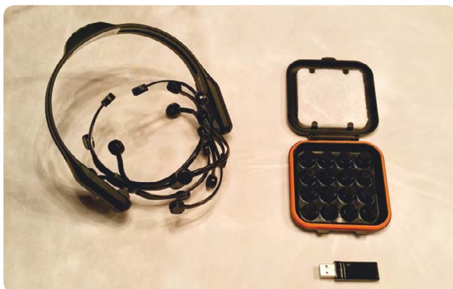
Rys. 3. Wykorzystywany do pomiarów neurohelm wraz z kasetą zawierającą elektrody oraz odbiornikiem sygnałów Fig. 3. Neurohelmet EMOTIV EPOC+ with a cassette containing electrodes and a signal receiver
