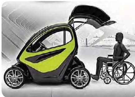
Rys. 3. Sposób wsiadania kierowcy do pojazdu razem z wózkiem inwalidzkim (Universal Design Style)
