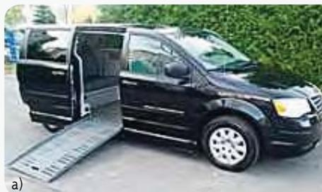
Rys. 9. Przykład pojazdu przystosowanego do przewozu osoby na wózku inwalidzkim: a – podjazd, b – winda, c – elementy do kotwiczenia wózka inwalidzkiego
