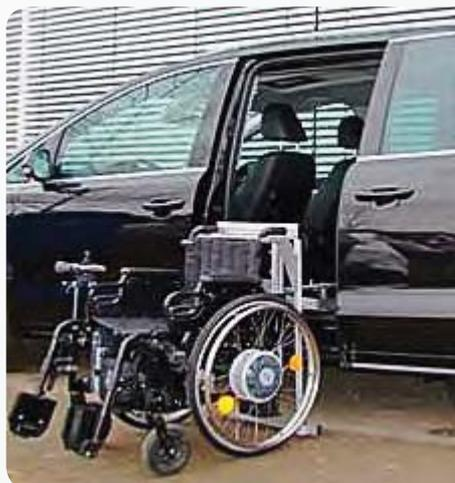
Rys. 8. System załadunku wózka inwalidzkiego na tylne siedzenie (na podstawie: Rausch Technik GmbH)
