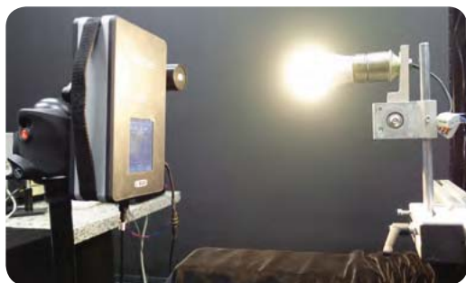
Fot. 4. Układ do pomiaru rozkładu widmowego źródła światła Photo 4. A set for measuring spectral distribution of a light source
