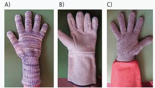
Fot. 5. Przykład rękawicy z dzianiny z przędzy impregnowanej niepalnie do ochrony przed czynnikami termicznymi (A, B, C) Photo 5. An example of a knitted glove made of yarn impregnated, nonflammable, to protect from thermal risks (A, B, C)
