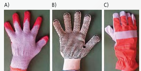
Fot. 1. Przykład rękawic chroniących przed lekkimi urazami rąk: dzianinowa powlekana całościowo polimerem od strony dłoniowej ułatwiającej chwyt przedmiotów (A), dzianinowa powlekana częściowo polimerem od strony dłoniowej ułatwiającej chwyt przedmiotów (B) oraz skórzano-tkaninowa (C), (źródło własne)
