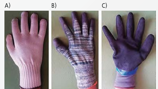
Fot. 2. Przykład rękawic dzianinowych chroniących przed średnio-ciężkimi urazami rąk z przędz z włókien polietylenowych o wysokiej odporności na przecięcie (A), z przędz o wysokiej odporności na ścieranie, przecięcie oraz wytrzymałości na rozdzielanie powlekana całościowo polimerem od strony dłoniowej ułatwiającej chwyt przedmiotów (B), z przędz o wysokiej odporności na ścieranie powlekana całościowo polimerem od strony dłoniowej ułatwiającej chwyt przedmiotów (C), (źródło własne)
