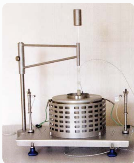
Fot. 3. Aparat do oznaczania minimalnej temperatury zapłonu warstwy pyłu [11]
