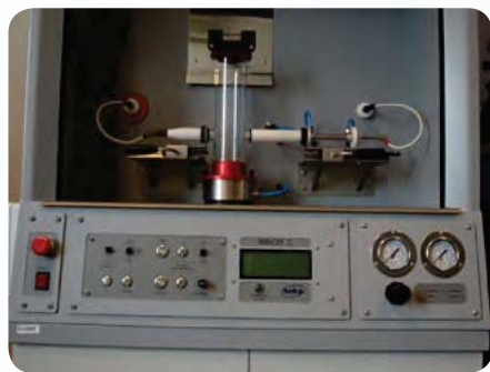
Fot. 2. MINOR 2 – aparat do oznaczania minimalnej energii zapłonu chmur pyłu (fot. CIOP-PIB)
