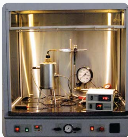
Fot. 4. Aparat Godbert-Greenwalda do oznaczania minimalnej temperatury zapłonu chmur pyłu [11]
