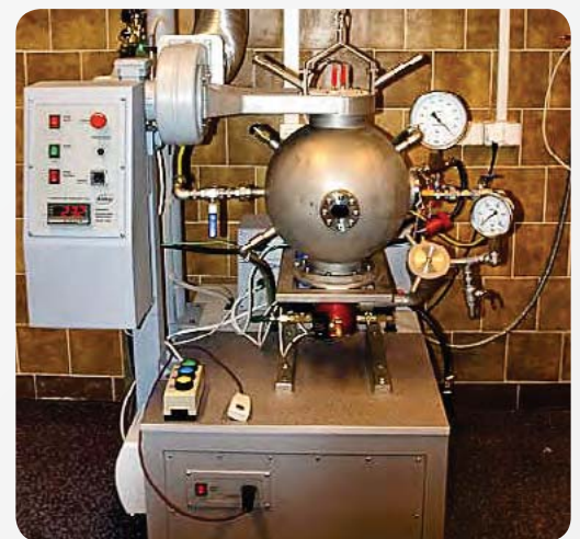
Fot.1. 20-L komora sferyczna do oznaczania parametrów charakteryzujących wybuchowość chmur pyłu (fot. CIOP-PIB)
