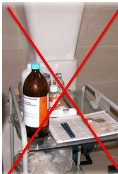
Rys 6. Tak nie należy przechowywać podręcznych ilości substancji i mieszanin chemicznych.
