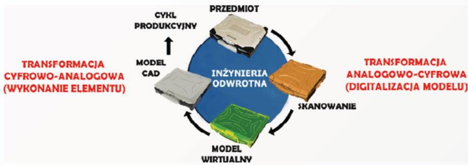
Rys. 1. Schemat projektowania wyrobów z wykorzystaniem inżynierii odwrotnej [10]
