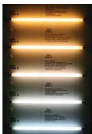
Fot. 3. Barwy światła białego i przykłady barw światła emitowanej przez typowe świetlówki [3] Photo 3. Colours of white light, and examples of colours of light emitted by a typical fluorescent lamp [3]
