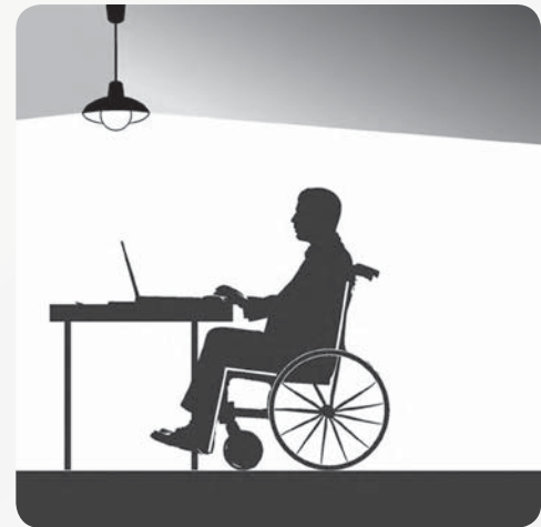
Rys. 2. Przykład olśnienia bezpośredniego od oprawy oświetleniowej zainstalowanej na stanowisku pracy biurowej z komputerem [3]
