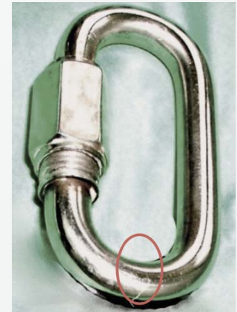
Rys. 9. Mikropęknięcie korpusu zatrzaski ze stali nierdzewnej powstałe na skutek procesów korozyjnych [3]
