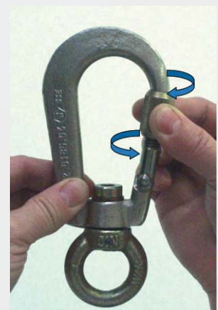
Rys. 3. Sprawdzenie możliwości zakręcenia i odkręcenia tulejki blokującej zatrzaśnika [3] Fig. 3. Test of twisting on and off a screwlink connector [3]
