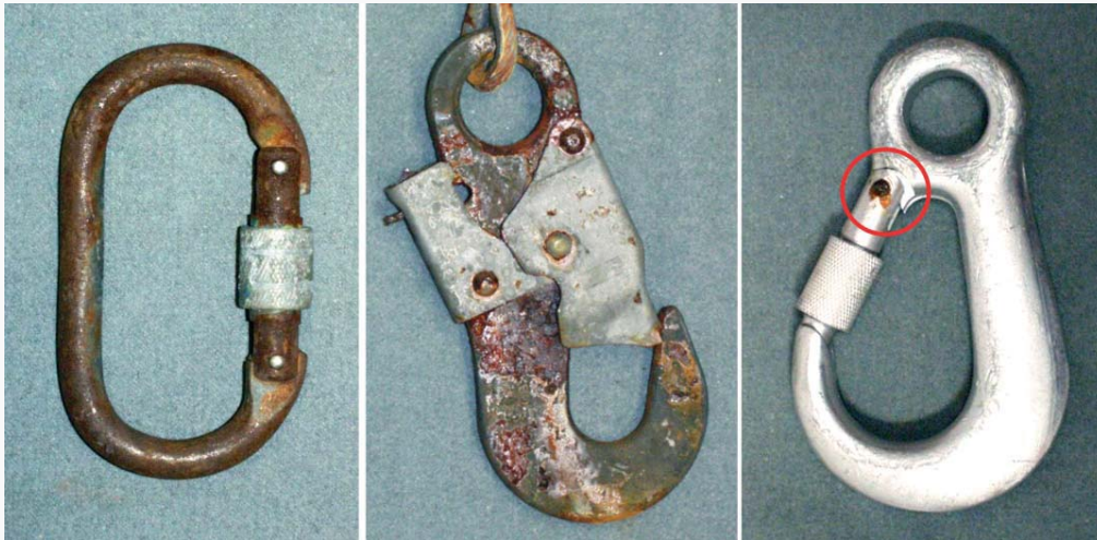
Rys. 8. Przykłady uszkodzeń korozyjnych zatrzasków [3] Fig. 8. Examples of corroded connectors [3]
