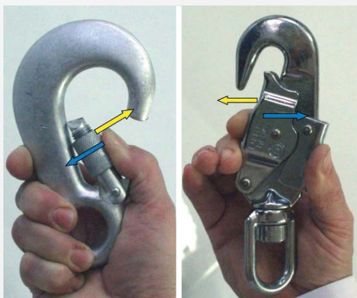
Rys. 1. Sprawdzenie samoczynnego zamykania się ramienia zatrzaśnika [3] ← – kierunek docisnięcia ramienia → – kierunek samoczynnej, prawidłowej reakcji ramienia Fig. 1. Test of a self-closing gate of a connector [3] ← – direction of the force used to open the gate → – direction of a proper automatic return of the gate
