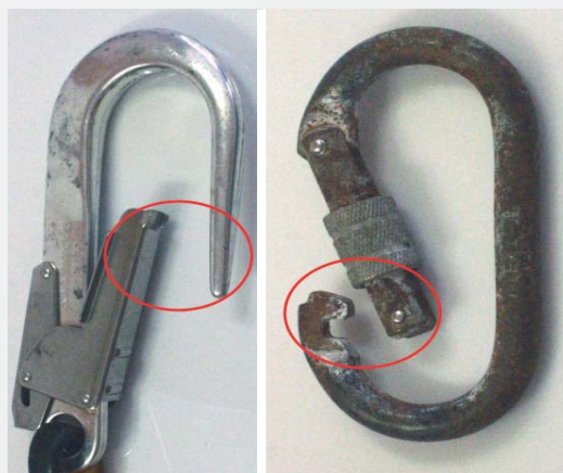
Rys. 2. Uszkodzenia zatrzaśników powodujące brak samoczynnego powrotu ramienia do pozycji zamkniętej [3] Fig. 2. Damage to connectors causing self-closing gates to malfunction [3]
