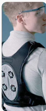
Rys. 2. Układ chłodzący powietrzem z wentylatorami umieszczonymi na plecach (zdjęcie opublikowane za zgodą www.mawashi.net )
