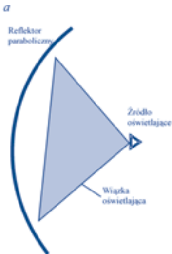
Rys. 2. Geometria symetrycznego reflektora parabolicznego
