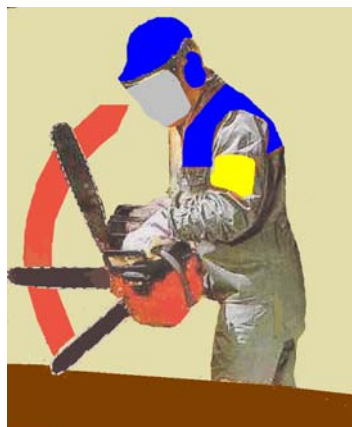
Rysunek 9. Odbicie pilarki: a) zjawisko odbicia, b) zetknięcie się górnej części końcówki prowadnicy z twardym przedmiotem
