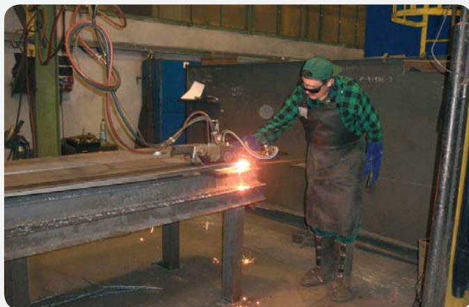
Fot. 1. Operator na stanowisku ręcznego ukosowania blach Photo 1. Operator at the manual beveling of metal sheets
