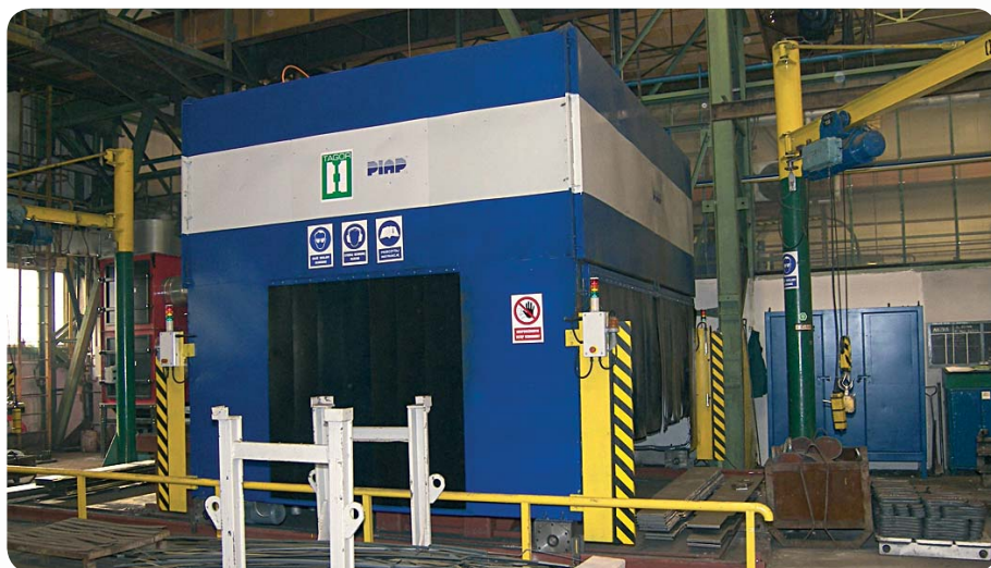
Fot. 3. Zrobotyzowane stanowisko ukosowania blach z cięciem plazmowym Photo 3. Robotized stand of beveling of metal sheets with plasma cutting
