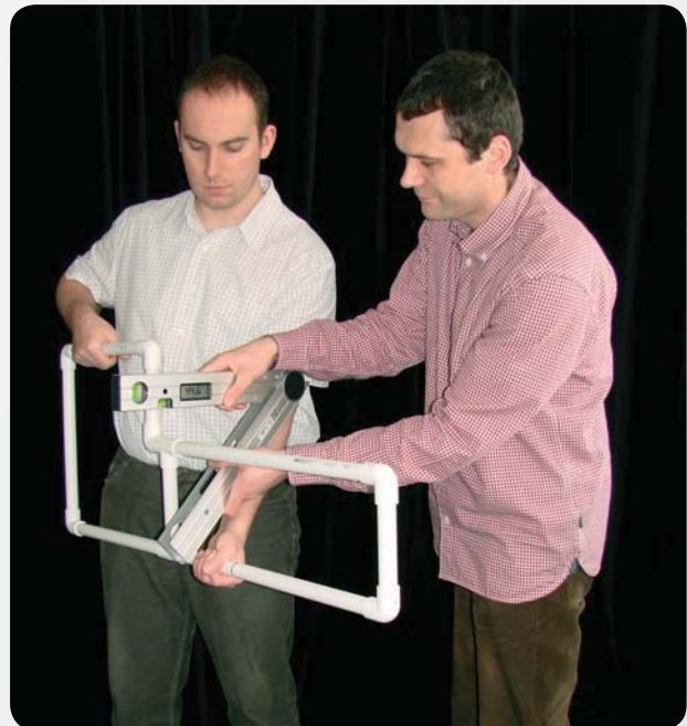
W. Leszko i P. Zradziński przy badaniach laboratoryjnych prowadzonych na potrzeby ustalenia parametrów realistycznych modeli cyfrowych ciała pracownika, wykorzystywanych przy analizie zagrożenia elektromagnetycznego i obciążenia biomechanicznego metodami numerycznymi
