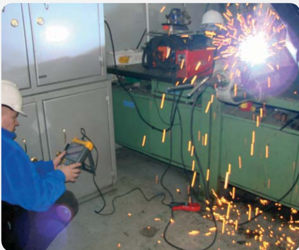
dr inż. K. Gryz w czasie badań parametrów pól elektromagnetycznych występujących przy urządzeniu przemysłowym
