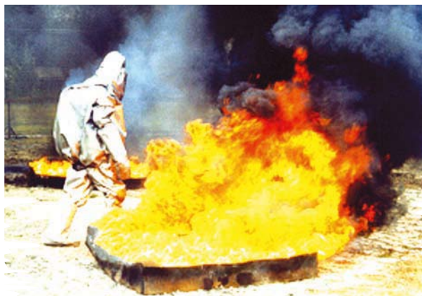
Odbijająca odzież ochronna zaprojektowana do zapewnienia ochrony przed wysokimi poziomami promieniowania cieplnego, ciepła konwekcyjnego i kontaktowego. (materiały CIOP-PIB)
