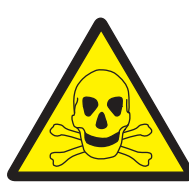
ostrzeżenie przed niebezpieczeństwem zatrucia substancjami toksycznymi
