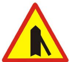
A - 6d wlot drogi jednokierunkowej z prawej strony
