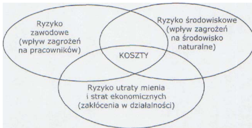
Rys. 19. Ryzyko związane z zagrożeniami w systemie: człowiek-obiekt techniczny-środowisko w zależności od rodzaju strat (PN-IEC 300-3-9)
