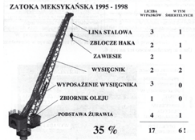
Rys. 1. Techniczne przyczyny wypadków na dźwigach oceanotechnicznych [11]
