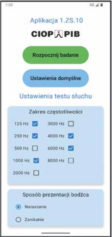
Rys. 6. Ekran z ustawieniami badania tłumienia wkładek przeciwhałasowych Fig. 6. Screen with settings for the measurement of earplug attenuation
