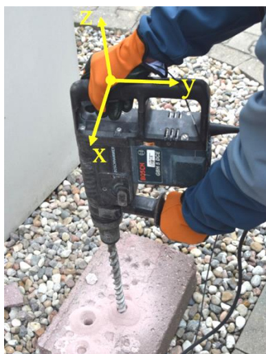
Projekt I.PN.09. Przykładowe wyniki badań weryfikacyjnych opracowanej rękawicy antywibracyjnej podczas pracy młoto-wiertarką
