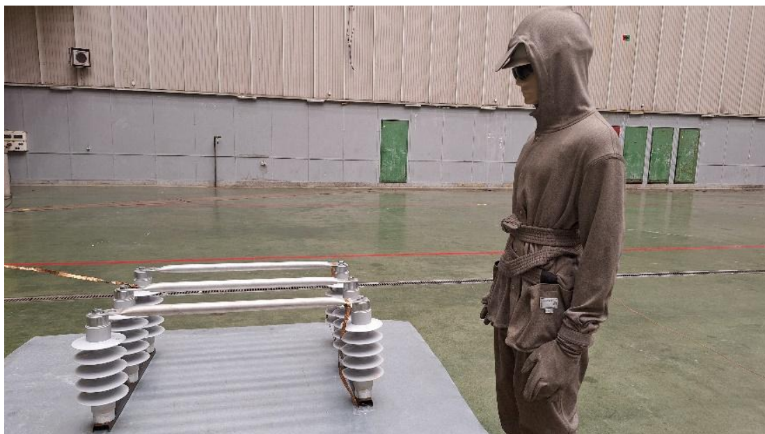
Projekt III.PN.11. Manekin ubrany w przewodzący strój i ustawiony w strefie oddziaływania pola elektrycznego
