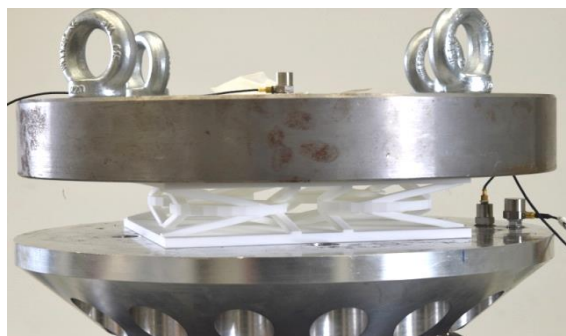
Projekt I.PN.10. Przykładowy element ustroju antywibracyjnego 3D podczas badań laboratoryjnych
