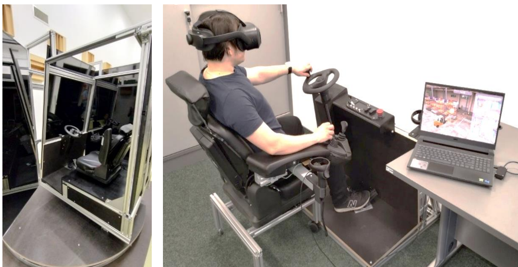
Projekt II.PN.08. Komponenty części fizycznej symulatora podnośnikowego wózka jezdniowego
