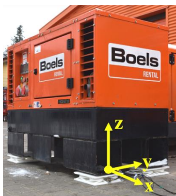
Projekt I.PN.10. Przykładowy ustrój antywibracyjny 3D podczas badań weryfikacyjnych oraz uzyskane charakterystyki częstotliwościowe drgań przed i po jego zastosowaniu
