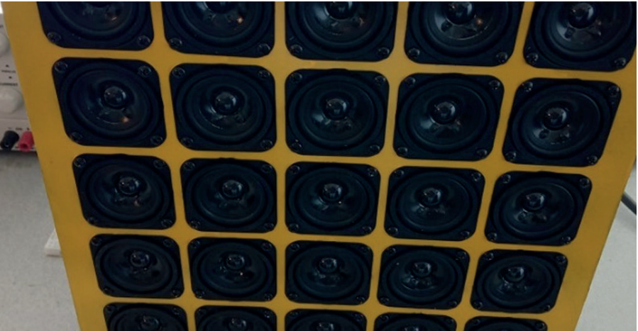
Fot. 4. Zmontowana kierunkowa matryca głośnikowa – widok z przodu Photo 4. Front view of the assembled directional loudspeaker array
