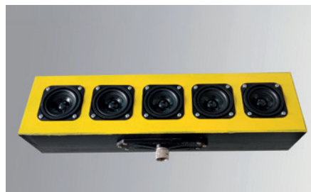
Fot. 2. Widok kierunkowego źródła liniowego po zakończeniu prac montażowych Photo 2. View of the linear source after the assembly work is completed
