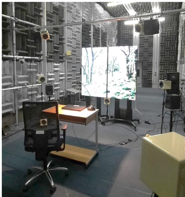
Projekt III.PN.12. Zmodyfikowane stanowisko laboratoryjne do odtwarzania dźwięku przestrzennego
